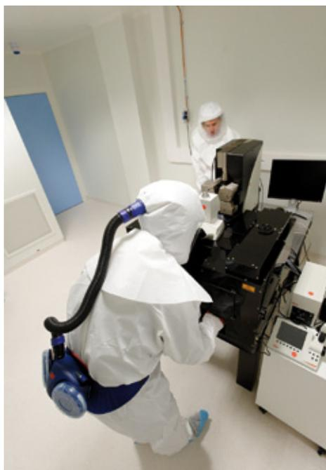
L'installation d'un microscope biphotonique - pour suivre de manière dynamique les événements moléculaires à l'intérieur d'une cellule vivante - en milieu BSL3 est une première. Pour faciliter sa maintenance, il a été installé en deux parties : le tableau de pilotage, avec les bancs laser, dans une zone non classée, et la partie observation en salle blanche (moins de 352 000 particules de 0,5 µm/m<sup>3</sup> d'air).
